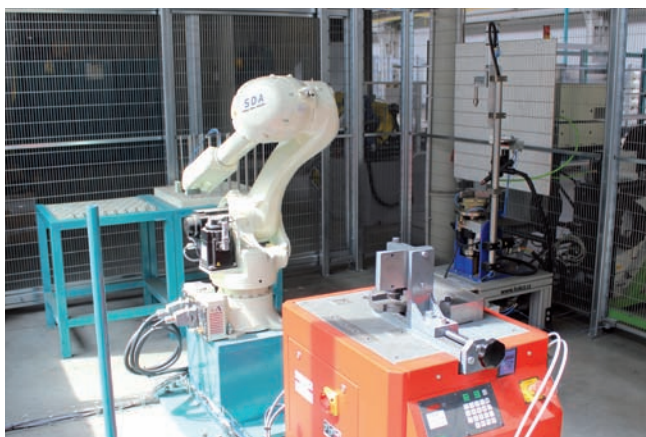
Robot zabezpečuje manipuláciu s materiálom a vďaka integrovanému PLC dokáže riadiť všetky procesy vrátane komunikácie so zväračkou a ohýbačkou.
