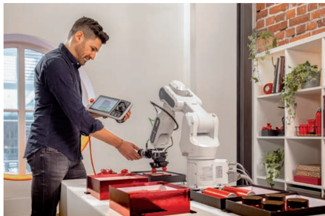
Jednoduché navádzanie robota SWIFTI™ funkciou lead through
