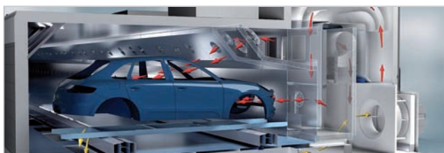
Sušiacia pec EcolnCure dosahuje najvyššiu kvalitu vďaka procesu ohrevu zvnútra von a optimalizovanému prúdeniu vzduchu, navyše je súčasťou siete IIoT.
